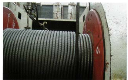
Perfekte Seilspulung nach Erneuerung
