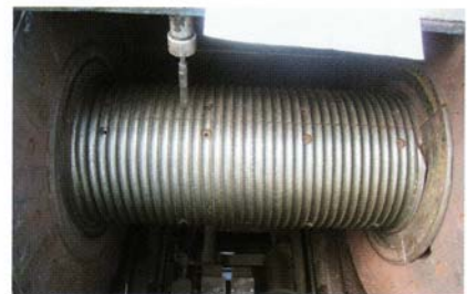
Verschlossene Seilspultrommel einer Bohranlage
